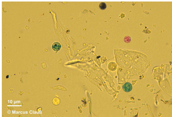
Abb. 1: Mikroskopisches Bild. Von organischen und mineralischen Staubpartikel in einer Büroluft.
