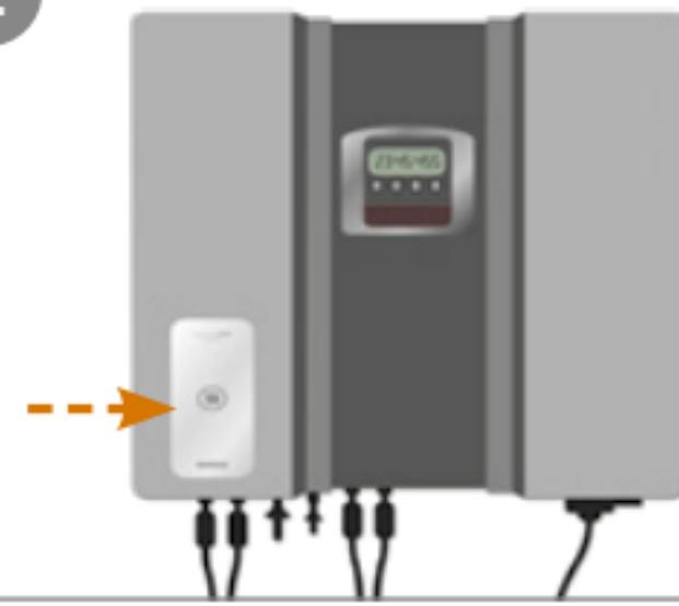
**DE** Befestigen Sie das Klettbänd an der Montagesstelle am Wechselrichter frontal bzw. seitlich oberhalb der Stringeingänge. Drücken Sie anschließend den memonizers**SUN** fest an. Die Oberfläche sollte fett- und staubfrei sein. Reinigen Sie diese bei Bedarf vor Aufkleben des memonizers.
