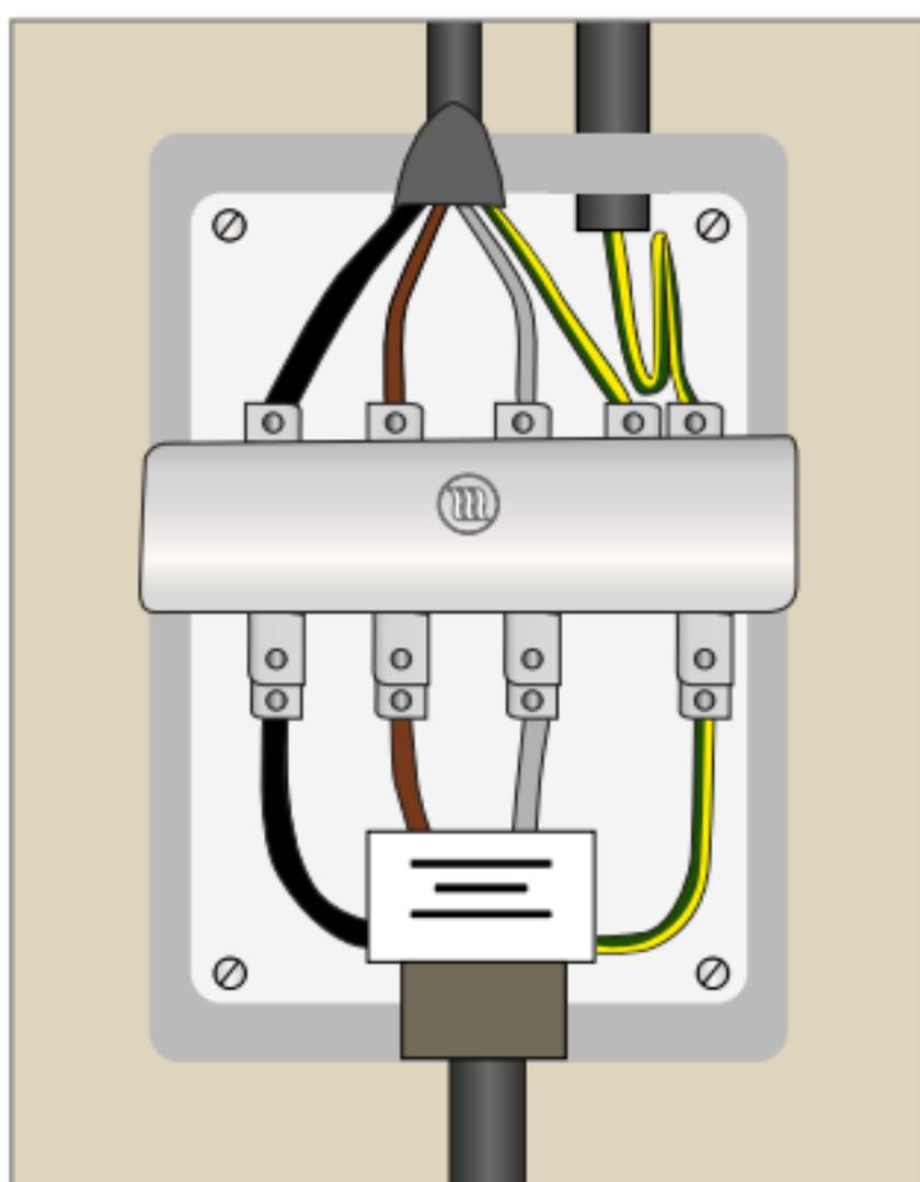
**DE** Bei der Montage am oder nach dem Stromzähler deckt der memonizer**COMBI** alle Stromkreise in einem Gebäude ab, die über die gleiche Hauptsicherung bzw. den gleichen Stromzähler laufen.
